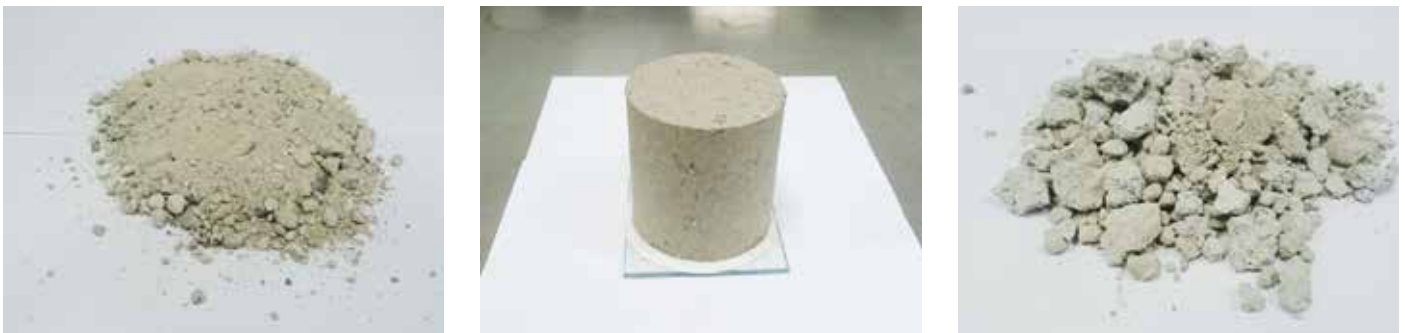
Bild 1: Untersuchte Körnungen/Probekörper am Beispiel der Probe B. Links: Originalkörnung 0/10 mm; Mitte: intakter Probekörper (Probe B + HSM); rechts: behandelte und anschließend gebrochene Probe in der Körnung 0/10 mm
