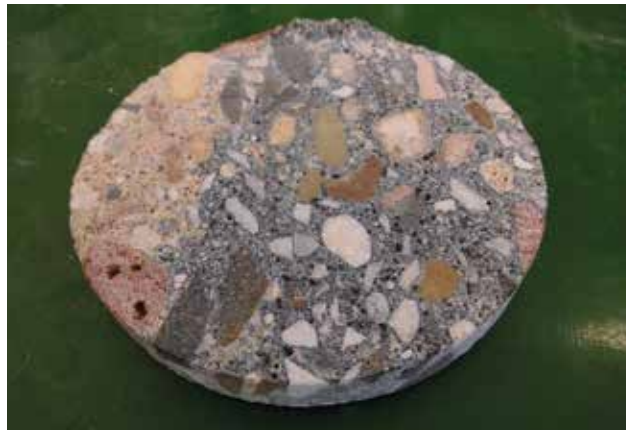
Bild 12: 2 cm dicke Scheibe aus dem 10-cm-Bohrkern Nr. 2
