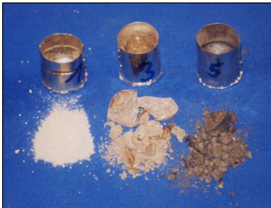
Bild 1: Bei der Abkühlung zerfallene Schlacke (links) und stabilisierte Schlacke (mittig, rechts) Röntgenographisch ist der Zerfall bzw. die Stabilisierung eindeutig auf die Ausbildung der \gamma -Modifikation bzw. \beta -Modifikation bei der Abkühlung zurückzuführen (Bild 2).
