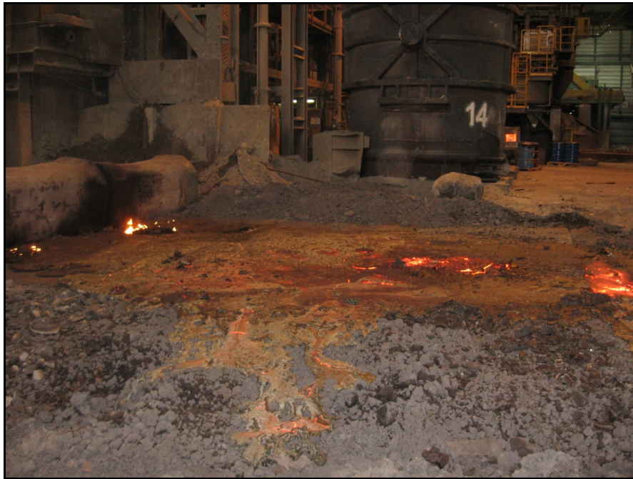
Bild 4: Sofortige schnelle Abkühlung in der Stahlwerkshalle
