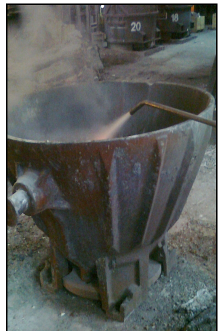
Bild 3: Einblasen von Konditionierungsmitteln in den Schlackentopf (Kaltvorversuch)
