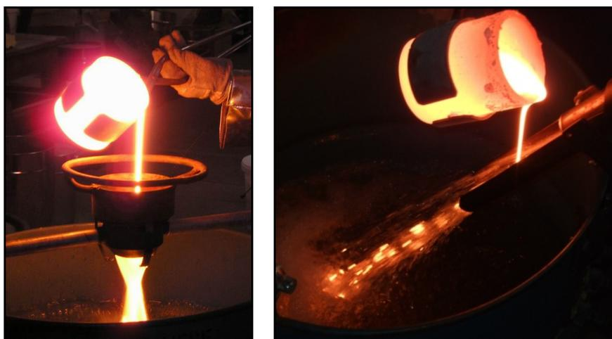
Bild 2: links: Standard-Laborgranulation (G1); rechts: Labor-Rinnengranulation (G3)
