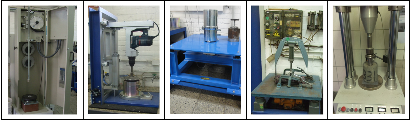
Bild 1: Verdichtungsgeräte nach DIN 18127 und DIN EN 13286-2 (Proctor), DIN EN 13286-4 (Vibrationshammer), DIN EN 13286-5 (Vibrationstisch), DIN EN 1744-1 (Rütteltisch) und CBR-Apparatur nach TP BF-StB und DIN EN 13286-47
