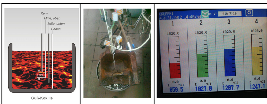
Bild 2: Versuchsanordnung zur Ermittlung des Abkühlverhaltens von schmelzflüssiger Hochofenschlacke in einer Graugußkokille und zugehörige Temperaturen in der erstarrenden Schlacke
