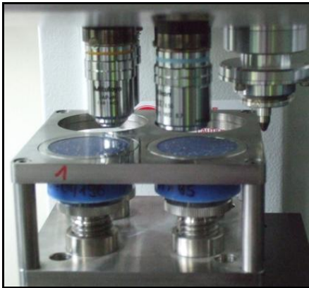
Bild 2: Vickershärteprüfung am Hüttensand HSD 257 (F = 0,2 kg), 623-663 HV 0,2
