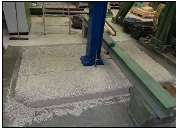
Bild 17: Hergestellte Platten für die Lastwechselfersuche im halbertechnischen Maßstab (v. l.: HGT 2, HGT 4, HGT 5)
