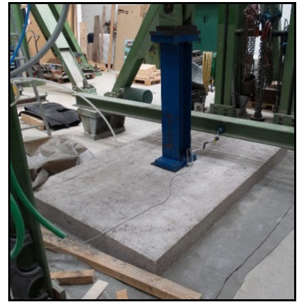
Bild 17: Hergestellte Platten für die Lastwechselfersuche im halbertechnischen Maßstab (v. l.: HGT 2, HGT 4, HGT 5)
