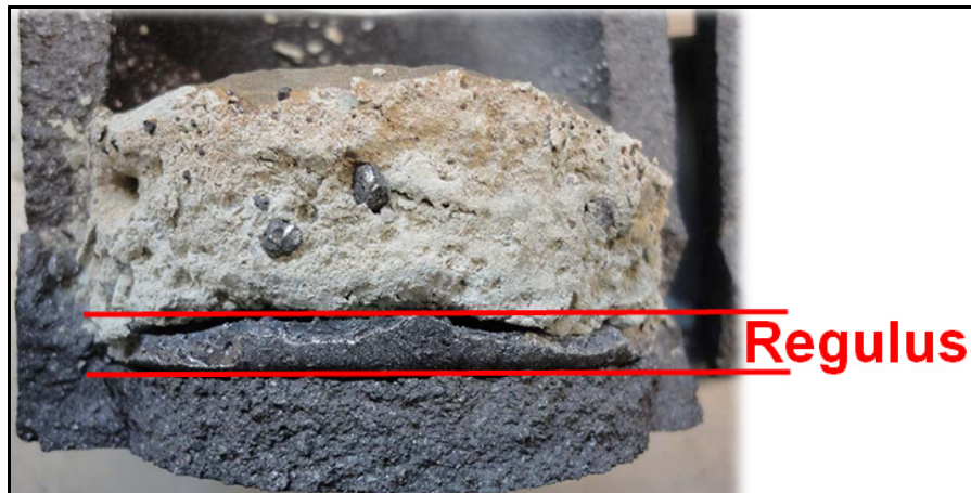
Bild 9: Schnitt des Kohlenstofftiegels nach Reduktion – Ausreduzierte Schlacke oben, gesammeltes Metall in Form eines Regulus unten
