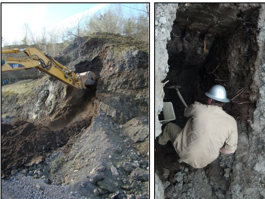
Bild 2: Baggerschürfe und manuelle Probenahme
