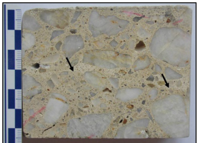
Bild 10: Farbliche Unterschiede zwischen oberflächennahem (oben) und Kernbeton (unten) in der Brückenkappe Auw / Kyll
