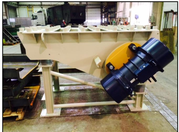
**Bild 5:** Schwingfördereinheit des Versuchsträgers
