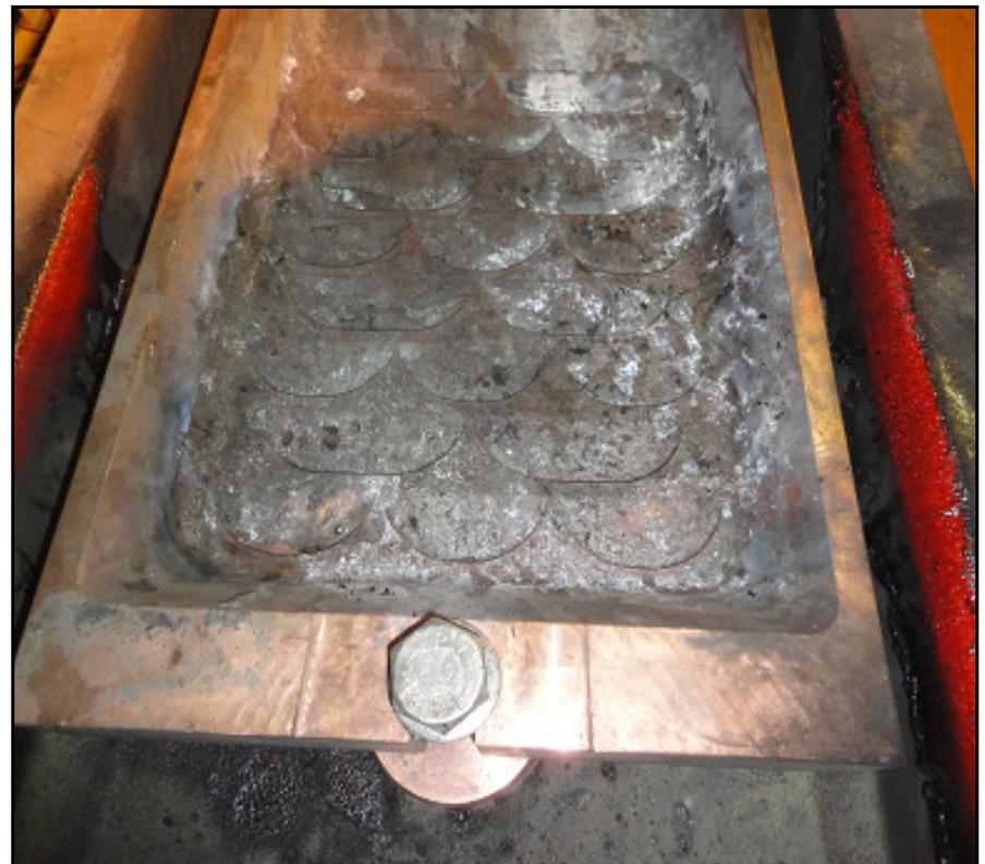
Bild 2: KKRR mit eingefräster Profilierung
