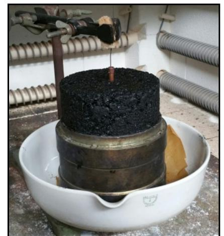
Bild 4: Messaufbau zum Erfassen der Temperaturabkühlkurven
