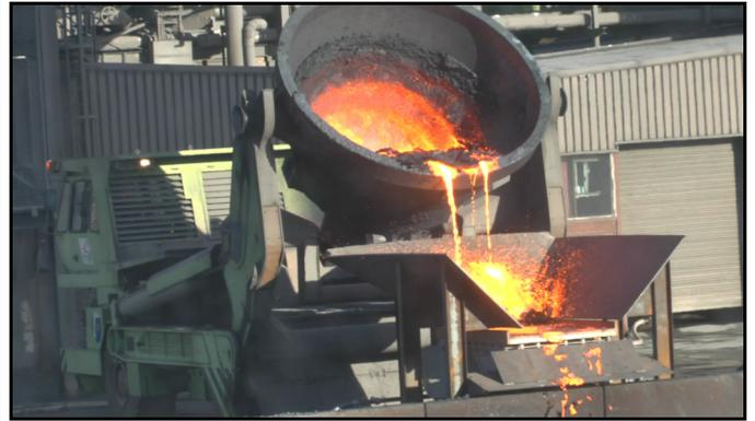
**Bild 8:** Erste erstarrte, noch heiße Schlacke verlässt den Versuchsträger
