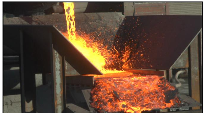
**Bild 10:** Rückstau vermehrt sich, Schlacke wird nicht mehr ausreichend erstarrt
