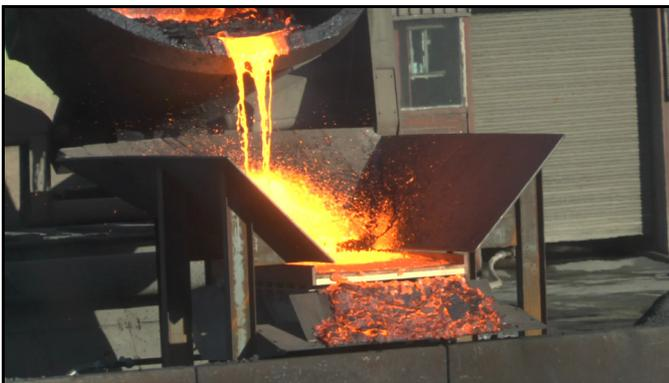
**Bild 9:** Nach längerer Kippzeit bildet sich ein Rückstau auf der Stufe
