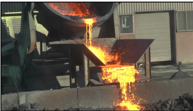
**Bild 11:** Flüssige Schlacke fließt über die erstarrte Schlacke auf der Stufe herüber
