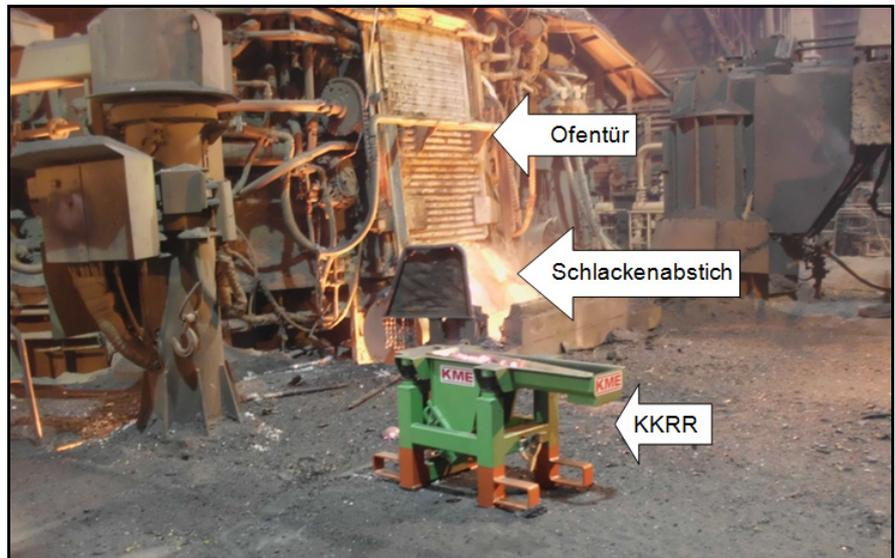
Bild 1: Probeabguss für 1. Betriebsversuchskampagne (ohne Förderung/Auffanggefäß)
