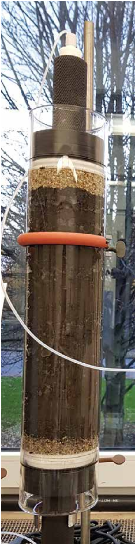
Bild 2: Perkolationsverfahren im Aufwärtsstrom
