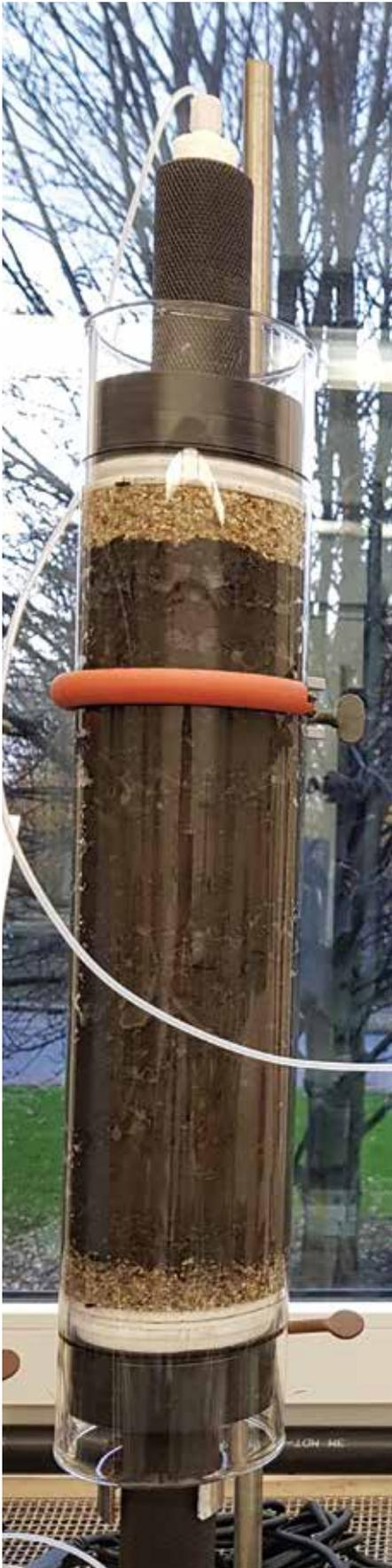
Bild 2: Perkolationsverfahren im Aufwärtsstrom
