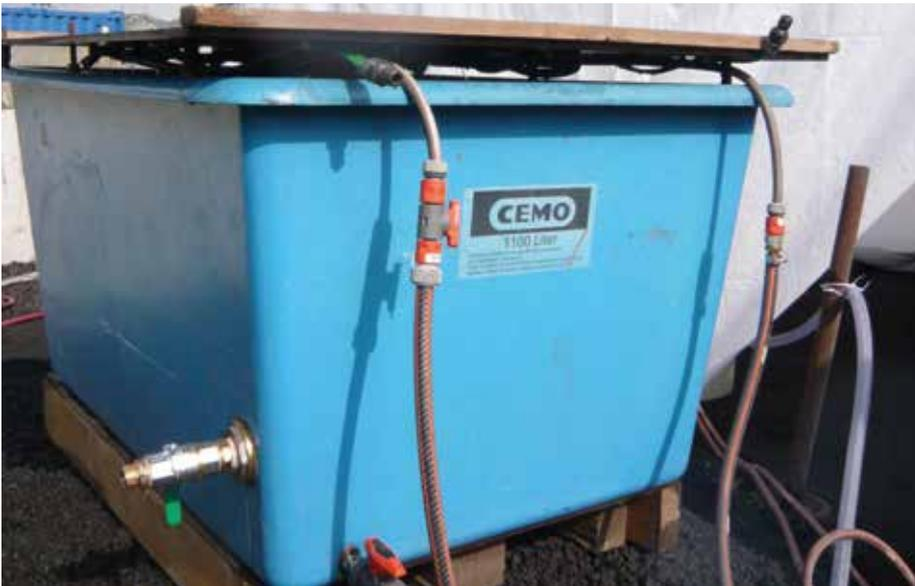
lauf vom Schlackewaschen wurde in einem Behälter gesammelt, lief von dort in einen zweiten Behälter mit pH-Messung und Neutralisation mittels Schwefelsäure über und wurde von dort in die Adsorptionsbehandlung gepumpt.
