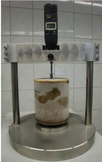
Abbildung 1: Messvorrichtung zur Erfassung der Frosthebung
