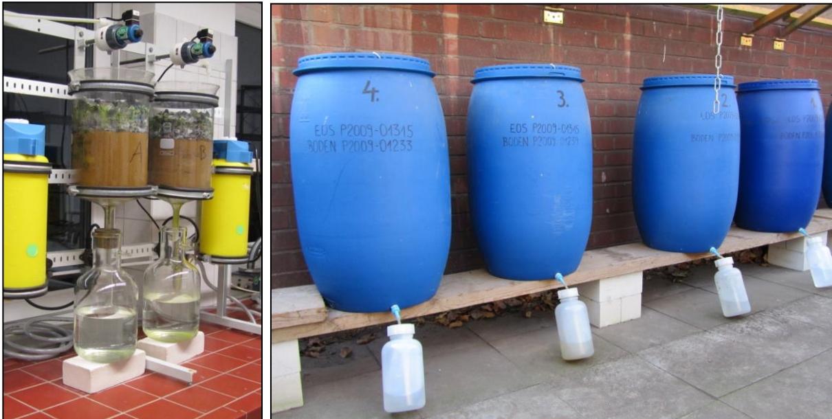
Bild 1: Fotos der Sprühsäulenanlage mit Beregnungsautomatik (links) sowie von Lysimetern im halbertechnischen Maßstab (rechts)
