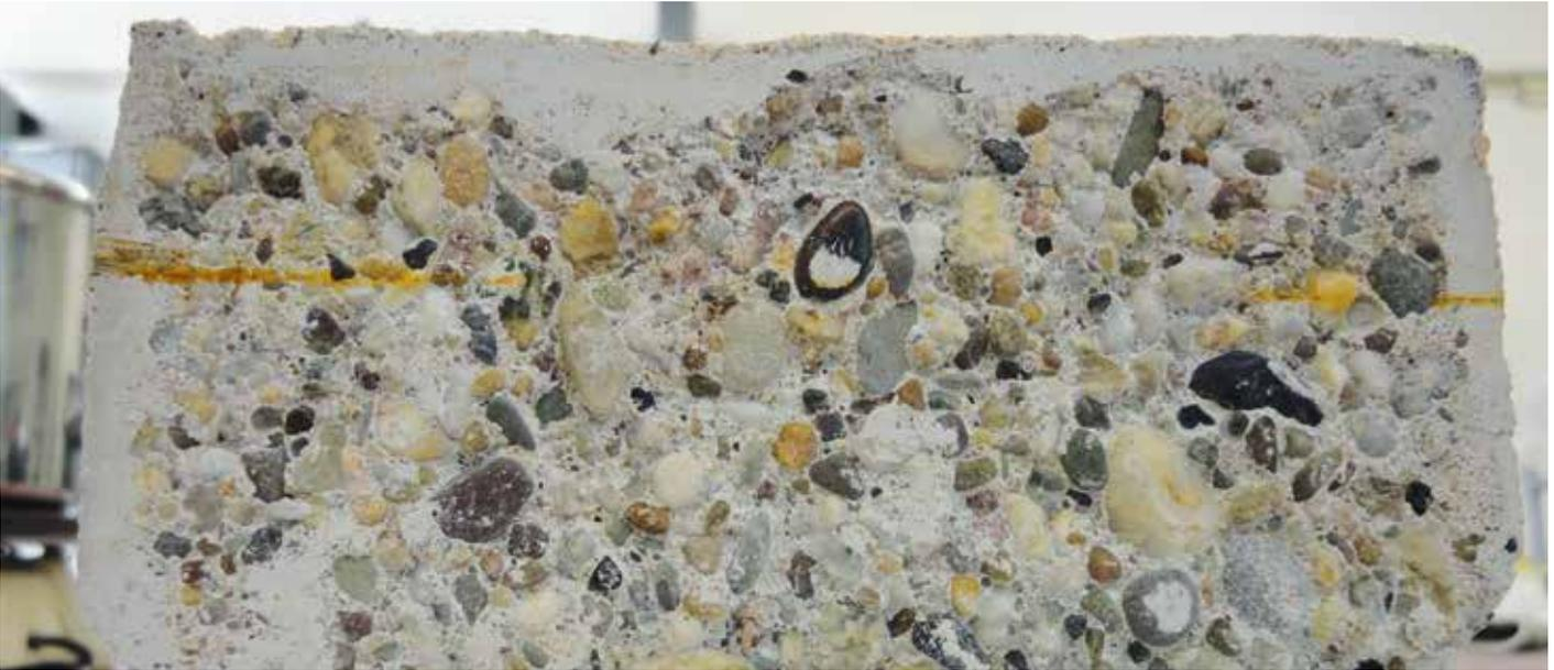
Bild 1: Probekörperbeschaffenheit bei mangelnder Verarbeitbarkeit des Betons mit alkalisch aktiviertem Hüttensand [15]
