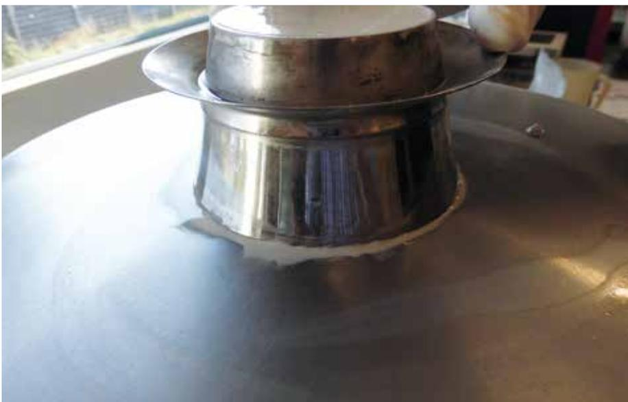
Bild 2: Entmischung des Mörtels N45T-31
