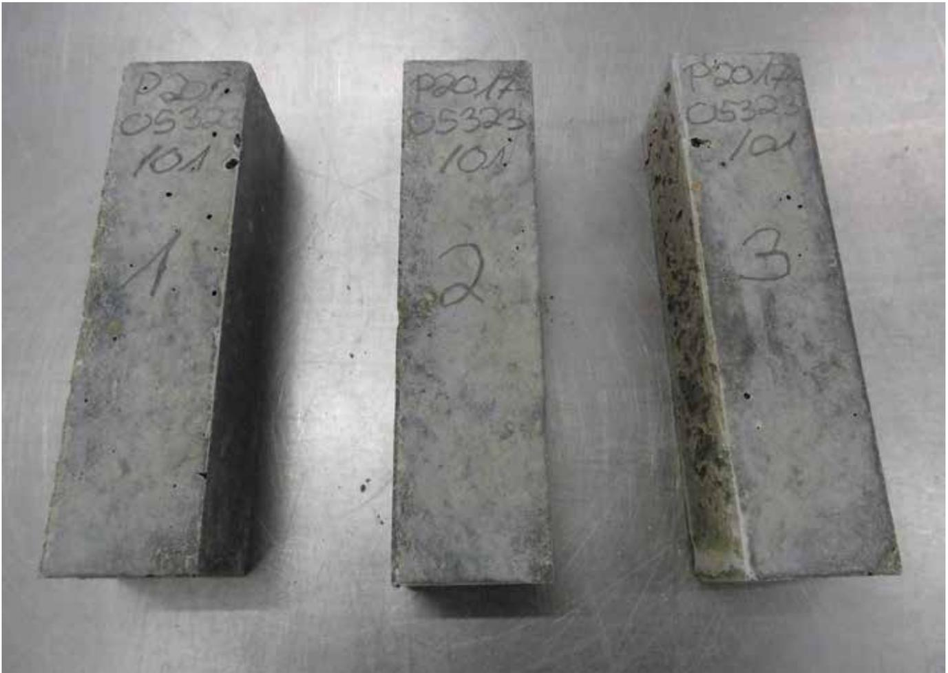
Bild 6: Beton AP6-6: Probekörper für die Prüfung des Säurewiderstands
