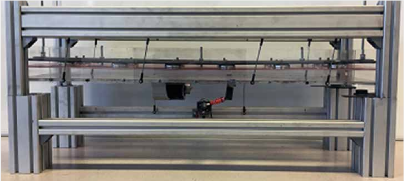
Bild 4: Trennrinne zur magnetischen Trennung der oxidischen Fraktion
