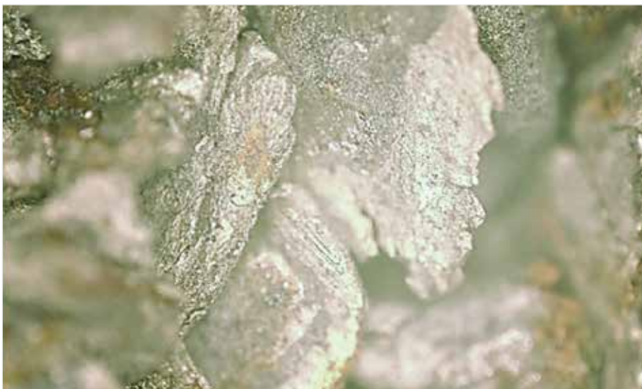
Bild 3: Duktil verformte Metallpartikel in den Fraktionen >250 µm
