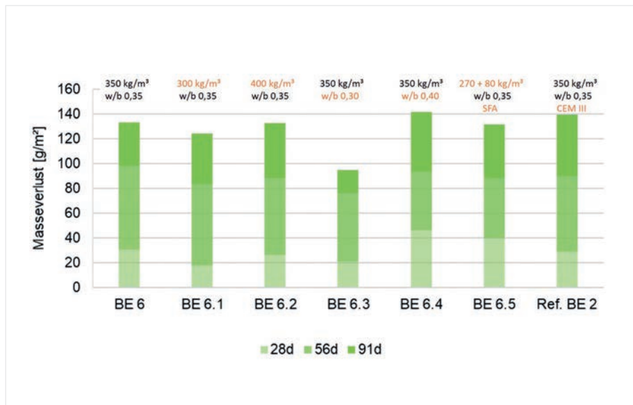
Bild 9: Masseverluste der Betone BE 6 nach 91-tägiger Lagerung in H_2SO_4 (pH 3,5)
