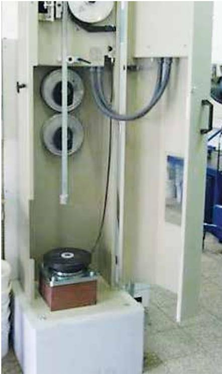
Bild 1: Proctorverdichter
