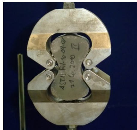
Bild 1: Prüfkörper zur Bestimmung der Zugfestigkeit nach ASTM C307-03
