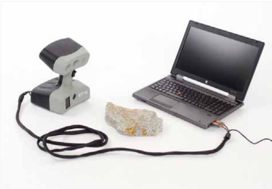
Bild 4: Messung mittels Handscanner-Methode
