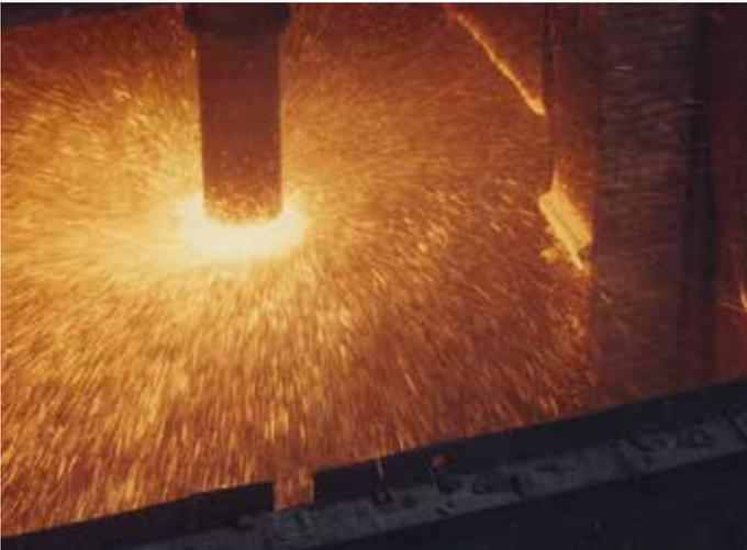
Bild 1: Pilotanlage zur Trockengranulation von Hochofenschlacke bei British Steel in Redcar [10]
