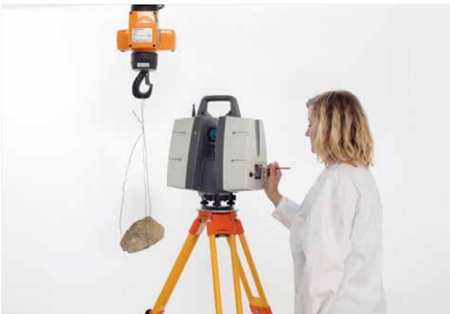
Bild 5: Messung mittels Laserscanner
