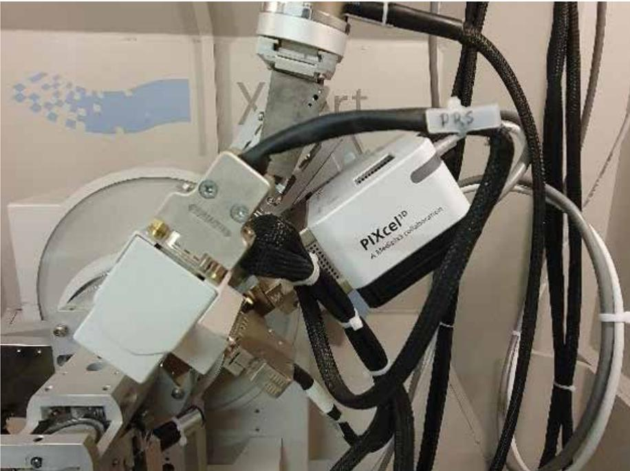
Bild 1: Detektorengeometrie im gebeugten Strahl. Gezeigt werden der neue PIXcel<sup>1D</sup> und der bisher verwendete Proportionalzähler mit vorgebautem Grafit-Monochromator.
