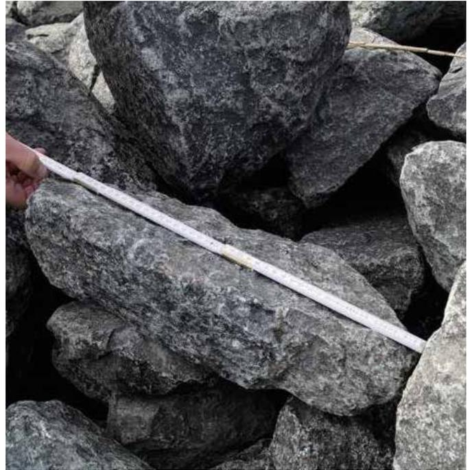
Bild 2: Ungünstig geformter Wasserbaustein mit einem Verhältnis von Länge zu Dicke  $> 3$
