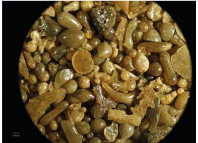
Bild 2: In Redcar erzeugte DSG-Pellets (Glasgehalt 99,5 Vol.-%)
