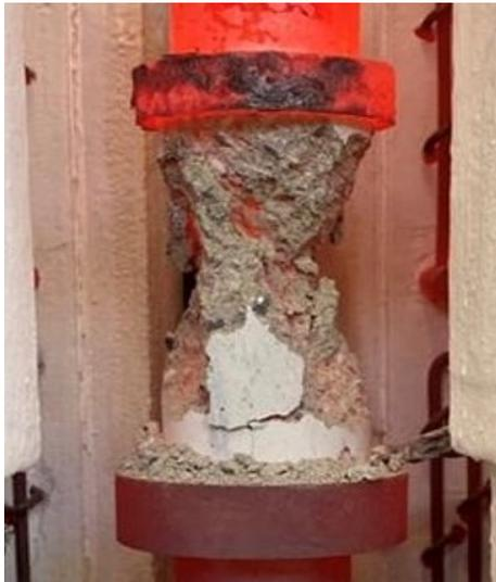
Bild 2: Prüfung der Heißdruckfestigkeit eines Betons
