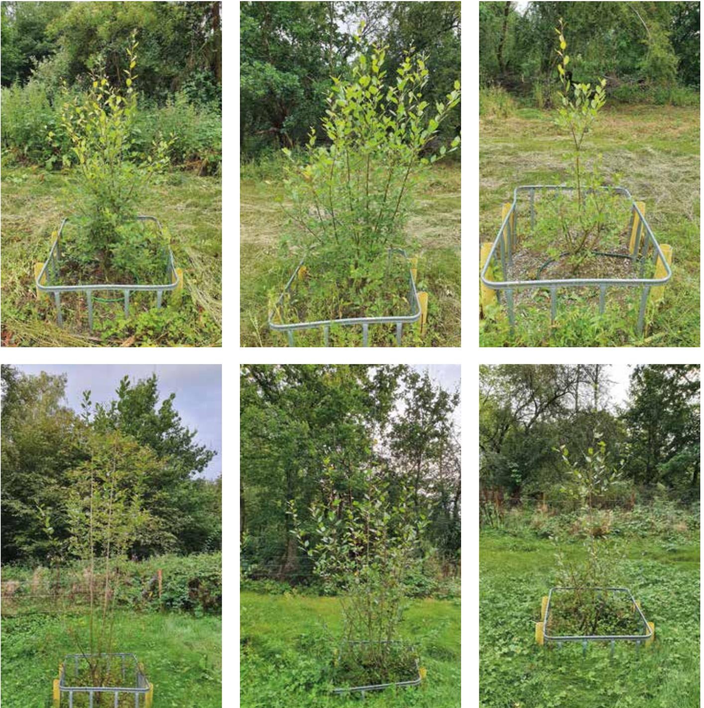
Bild 5: Weiden im Juni 2020 in den Substratmischungen 1A (Lava), 2A (HOS 2), 3A (HOS 1) (oben); Weiden im September 2021 in den Substratmischungen 1A (Lava), 2A (HOS 2), 3A (HOS 1) (unten)
