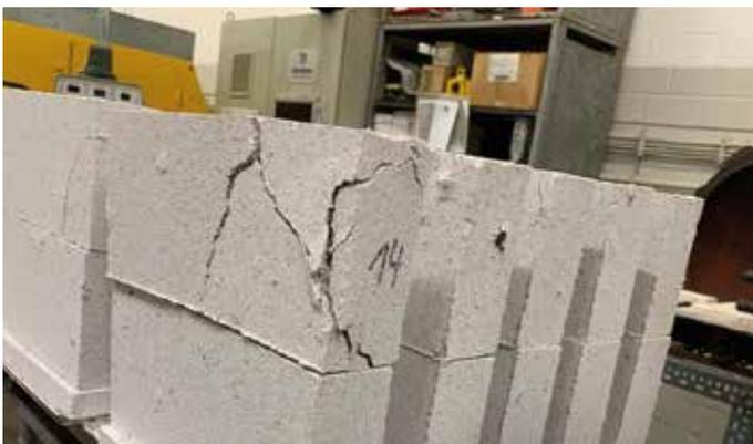
Bild 15: Geschädigte Kalksandsteine mit 10 M.-% LDS-2 aus dem Technikumsversuch
