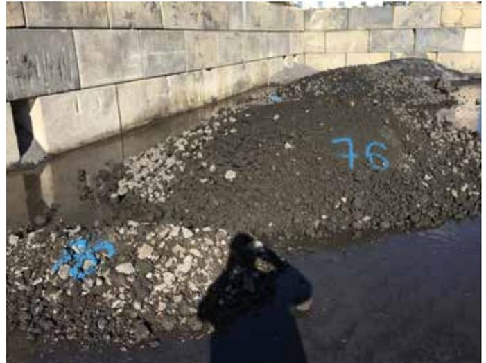
Bild 10: Rohschlacke vor und nach der Aufbereitung, separiert nach Chargen
