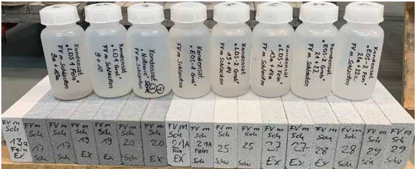
Bild 17: Einige der Prüfkörper für die Eluatuntersuchungen sowie zugehörige Härtekesselkondensate aus den zahlreichen Technikumsversuchen
