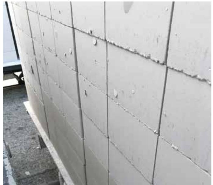
Bild 10: Schadstelle an Kalksandstein mit LDS-1 nach dem Werksversuch 2
