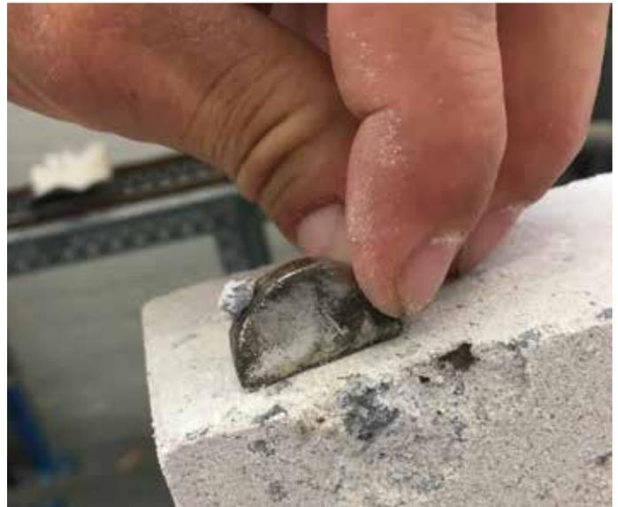
Bild 14: Magnetisches LDS-1-Korn aus einem im Technikum hergestellten Kalksandstein
