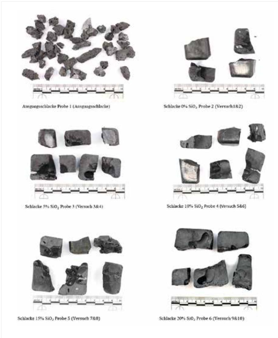
Bild 3: Makroskopische Aufnahmen der erstarrten Schlacken
