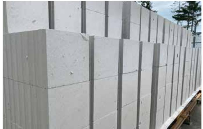
Bild 9: Kalksandsteine mit LDS-1 vor (links) und nach (rechts) dem Autoklavierungsprozess im Werksversuch 2
