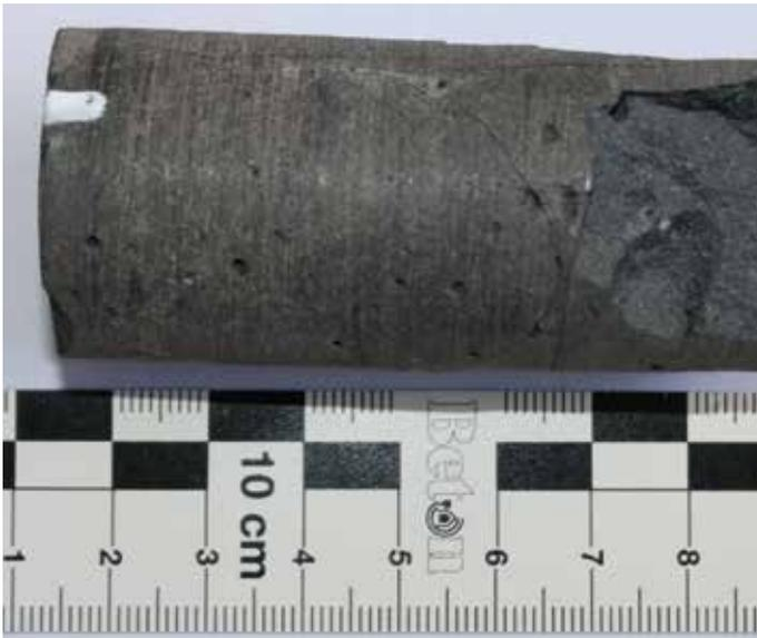
Bild 13: Geschädigter 5-cm-Bohrkern aus LDS-1 nach Dehnungsversuch
