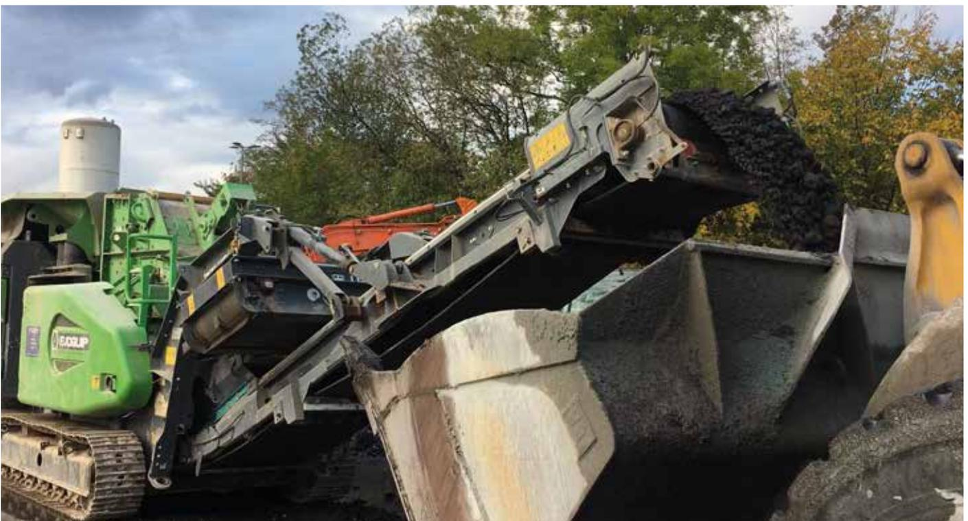
Bild 11: Aufbereitung der behandelten EOS mittels mobiler Anlagen
