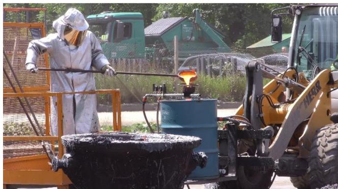
Wassergranulation ein ähnliches Produkt zu erzeugen, wie den heutigen Hüttensand, welcher in der Zementindustrie eingesetzt wird. Mit dem mobilen Wassergranulations-equipment wurden so Versuche im Werk durchgeführt, sodass nach den ersten, besonders guten Ergebnissen,
