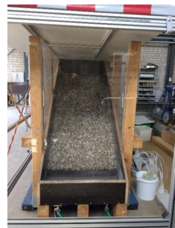
Bild 12: Lysimeter mit eingebautem Material und Dränschicht (Kies)
