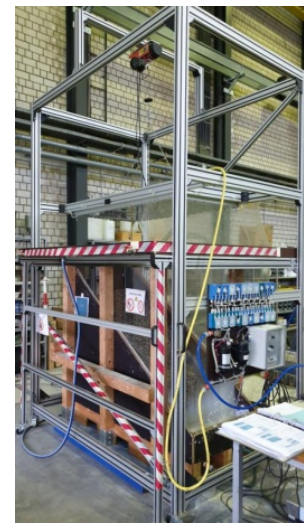
Bild 10: Hallenlysimeter mit Sensorik und Berechnungseinheit
