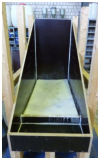
Bild 9: Hallenlysimeter leer, Frontansicht
