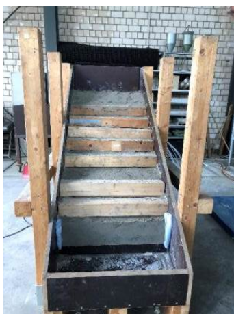
Bild 12: Lysimeter mit eingebautem Material und Dränschicht (Kies)
