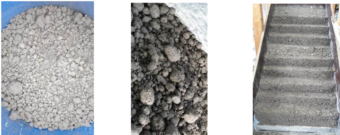
Bild 13: Pelletbildung nach der Materialanmischung und folgender Effekt auf den Einbau der Mischungen GPS 87 K 13 , GPS 80 K 20 und LDS 80 K 20
