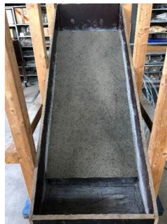
Bild 12: Lysimeter mit eingebautem Material und Dränschicht (Kies)
