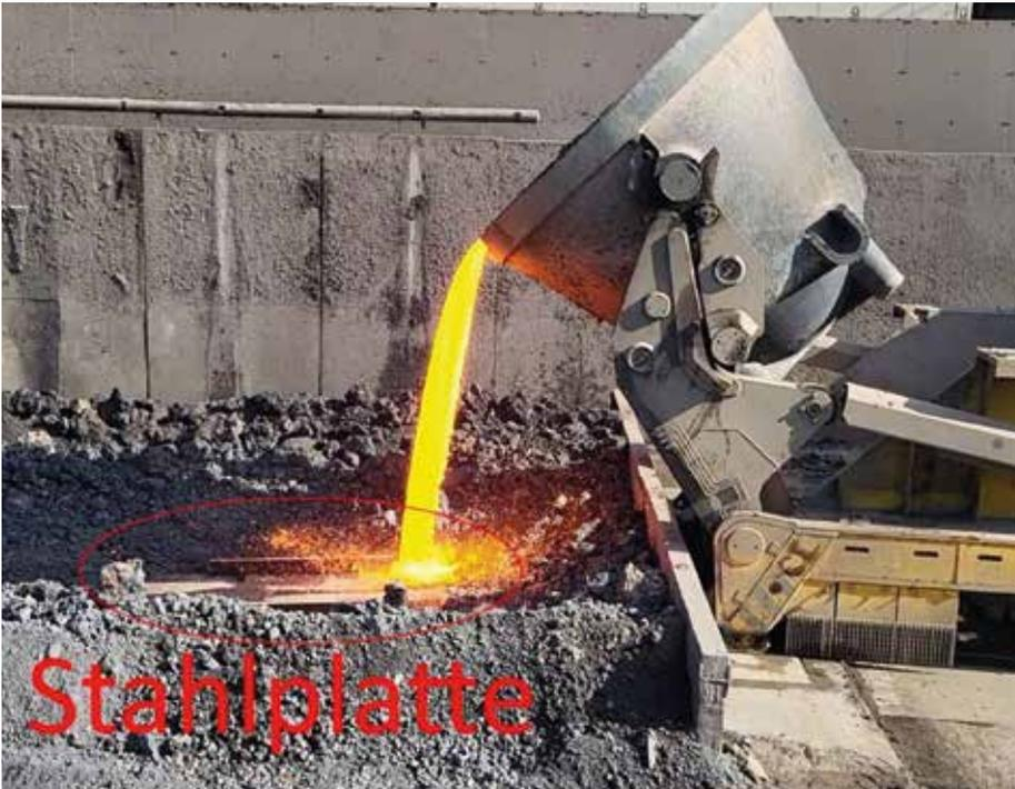
Bild 3: Abkippen einer Schlacke auf eine Stahlplatte im Schlackenbeet
