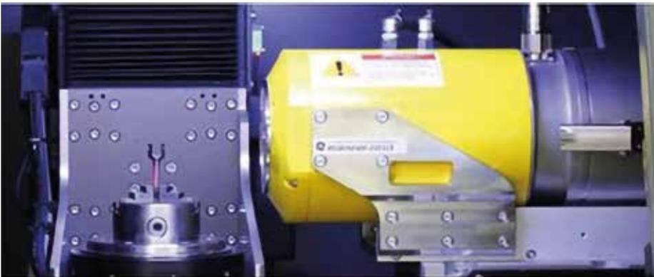
Bild 6: Messeinrichtung für die 3D-CT (Nanotom® M: 180-kV-Röntgenquelle; 360°-Drehung)
