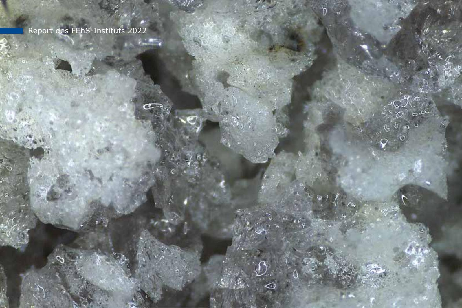
nicht monoton mit steigender Porosität der weiteren Hüttensande. Hieraus wird das Fazit für die geometrisch komplexen, realen Hüttensandkörner gezogen, dass der allein durch die Porosität verursachte Einfluss auf die Bruchfestigkeit durch weitere Einflussgrößen überdeckt werden kann.
