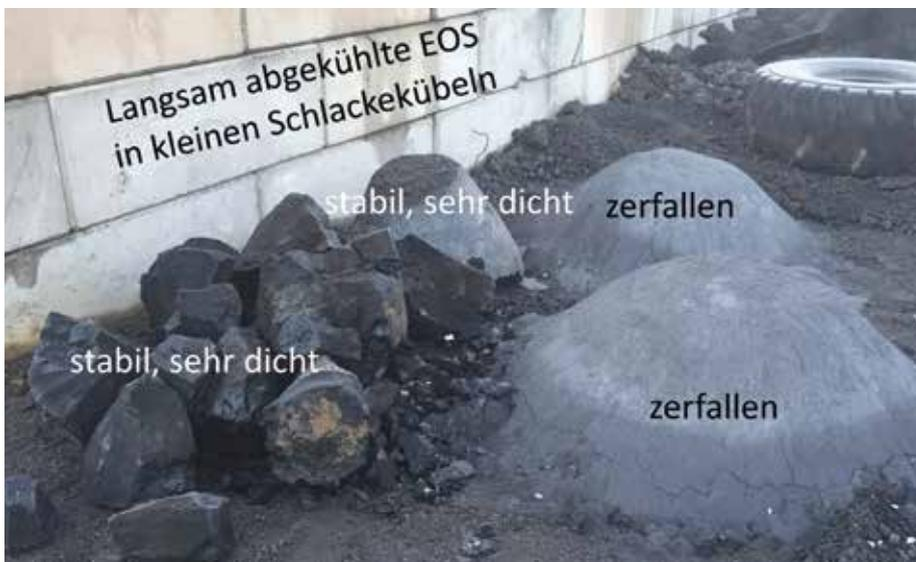
Bild 6: Vier Chargen langsam abgekühlte EOS, davon 2 x dicht und stabil und 2 x zerfallen
