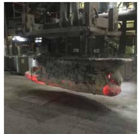
Bilder 7: Transport des Sandwichs wie ein Mobile am Hallenkran
