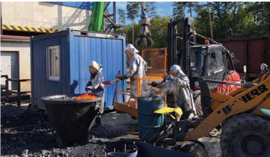
Bild 9: Wassergranulation größerer Mengen an EOS zur Nutzung im Zement
