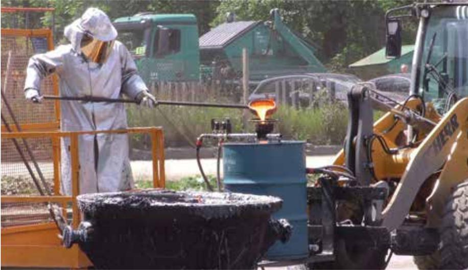
Bild 8: Wassergranulation von Elektroofenschlacke aus kleinem Kübel am Schlackenbeet
