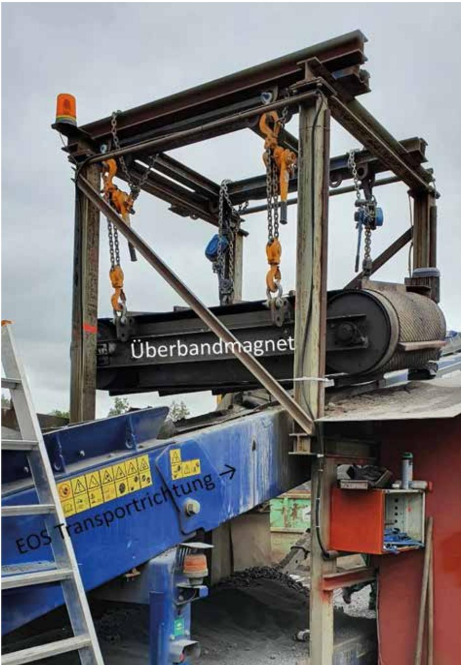
Bild 7: Herablassen des Überbandmagneten auf die niedrigste Einstellung zur Erhöhung der Magnetfeldstärke auf die EOS
