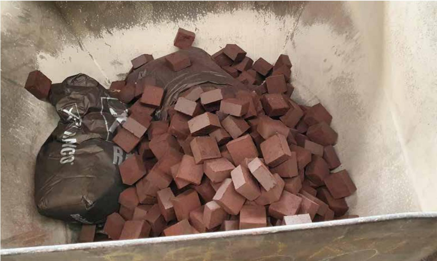
Bild 7: Filterschlammagglomerate und Kokssäcke vor dem Chargieren in den Elektrolichtbogenofen
