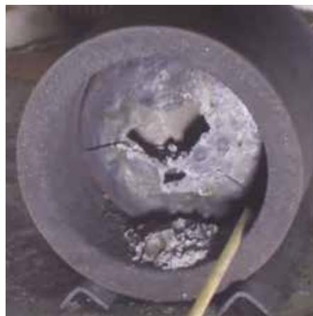
Bild 4: POS im Muffelofen mit Thermolement während des Zerfalls
