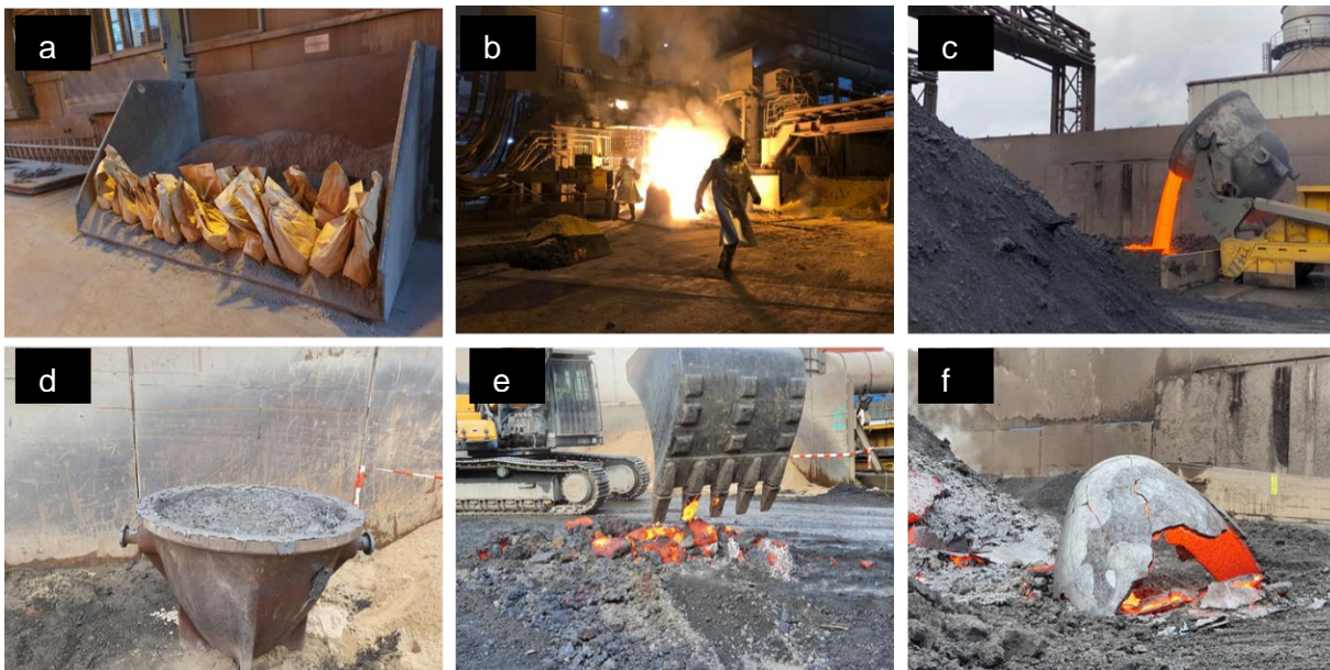
Bild 1: Betriebsversuche zur Schlackenconditionierung; a: Säcke mit Flussspat, b: Abstich der Schlackenschmelze, c: Abgießen der Schlacke ins Beet, d: leerer Schlackenkübel, e: Beprobung der Beetprobe, f: Beprobung des schnell erstarrten Kübelrands.
