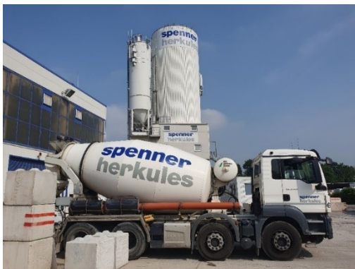
Bild 2: Frischbetonlagerung im Fahrmischer bei üblicher Rotation der Mischtrommel
