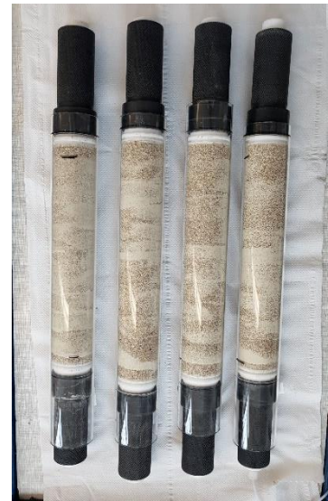
Bild 1: Proben-Quarzsand-Mischungen mit unterschiedlichen Quarzsandkörnungen
