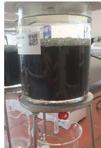
Bild 2: Quellfähige Probe in einem optimierten GLHC-Trog
