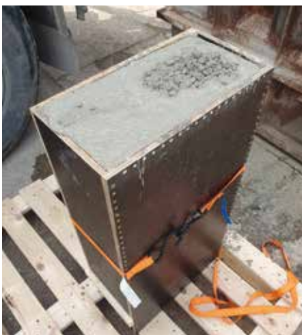
Bild 10: Herstellung des Wandelements im Transportbetonwerk der Spenner Herkules GmbH und dessen Lagerung im FEhS-Institut
