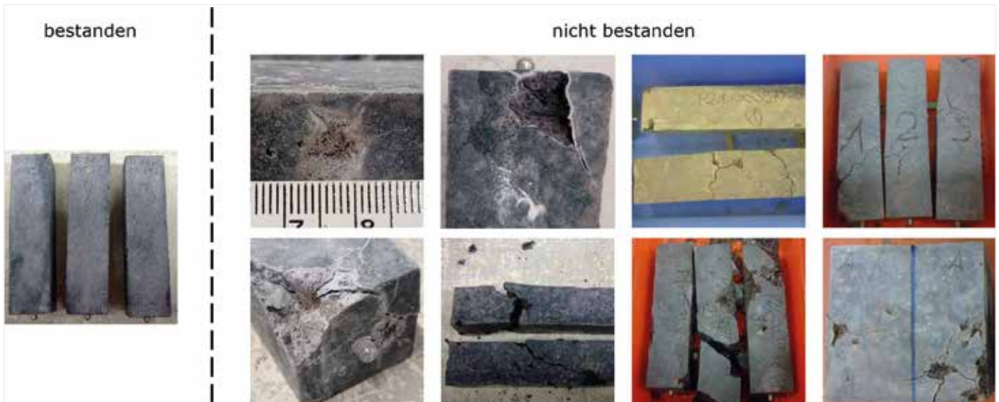
Bild 1: Visuelle Bewertung der Raumbeständigkeitsprüfung der Gesteinskörnungen. Kategorie 1 (links) = keine Schäden = bestanden. Kategorien 2 bis 5 (rechts) = Schäden in verschiedenen Intensitäten = nicht bestanden
