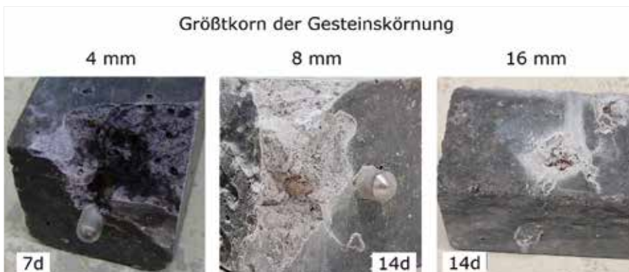
Bild 2: Schädigungsintensität von Beton mit einem w/z -Wert von 0,60, einem Freikalkgehalt der Gesteinskörnung von 1,9 M.-% und einer Prüftemperatur von 60 °C in Abhängigkeit vom Größtkorn der Gesteinskörnung
