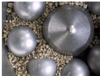
Hüttensand in der Mahlschüssel des Zeiselgeräts
